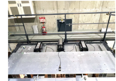
設備耐震実験用振動台
